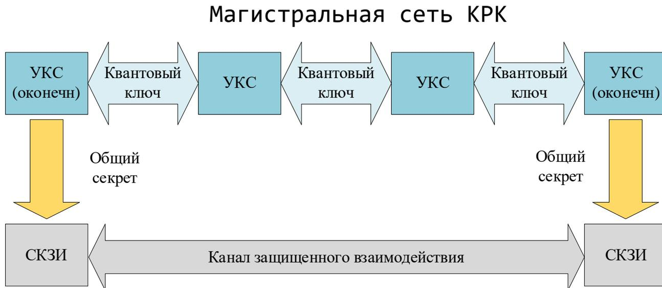
**Задача:** Распределить общий секрет (КЗК) между окончными узлами сети КРК (УКС)
